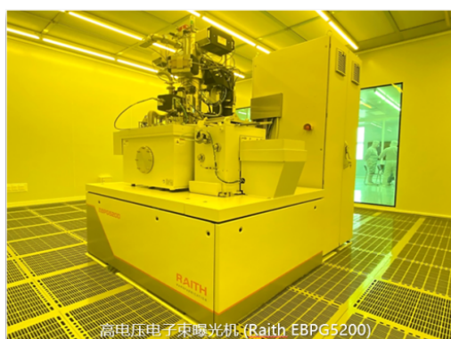
高电压电子束曝光机 (Raith EBP5200)
